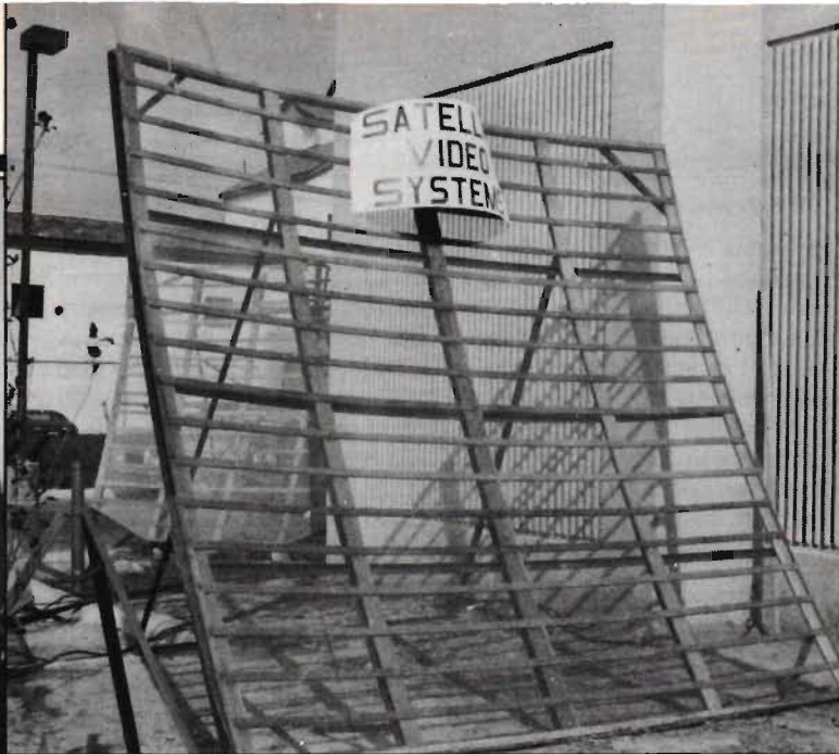
Fig 5. Det finns flera antenntyper än parabolantennor som kan användas. Här ser vi en sfärisk reflektor.
