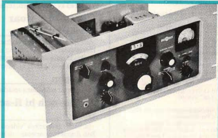
Fig 1. "Funktionell chassi-lay-out", berömd av Collins av i textpresentationen av 51 S-1 då den debuterade 1960. Avstämningen sades vara speciellt resistent mot stötar och påkänningar och mot tidigare mottagare hade frekvensindikeringen förbättrats med bla annan inledning av skalan.
