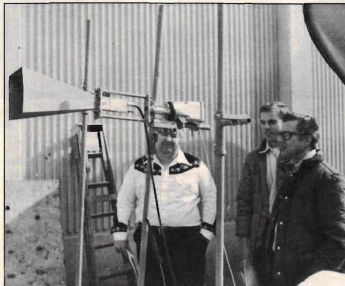
Fig 6. Den sfäriska reflektorn (i fig 5) matas med ett horn av det visade slaget. Intrimningen kan vara något besvärlig medan en sfärisk reflektor är lättare att tillverka än en parabolformad.
