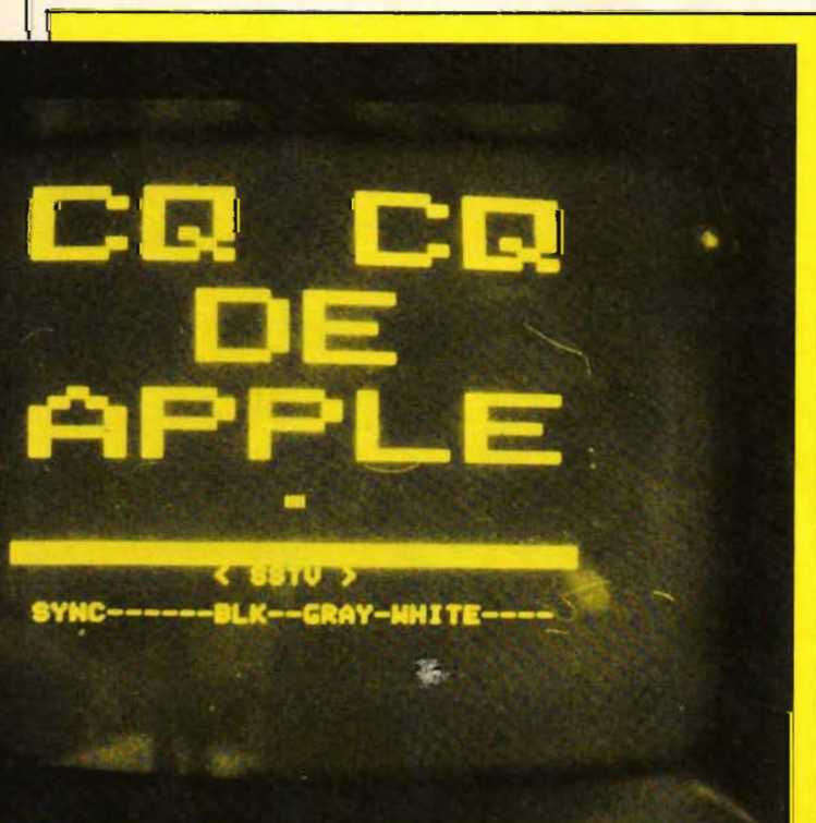
Fig 1. Här ser vi ett exempel på en bild för smalbandig tv, sstv. Den är genererad på en Apple II -dator, som med ett passande program förvandlas till sstv-terminal.
