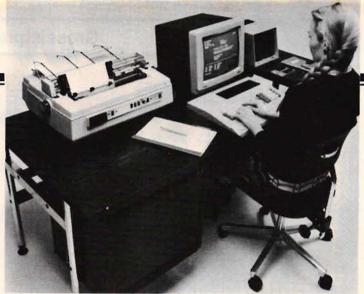
Den här miljön blir vanlig för ABC 800. Bildskärmen är anpassad för ändamålet med 80 tecken per rad och skärmen är gul samt antireflexbehandlad.
