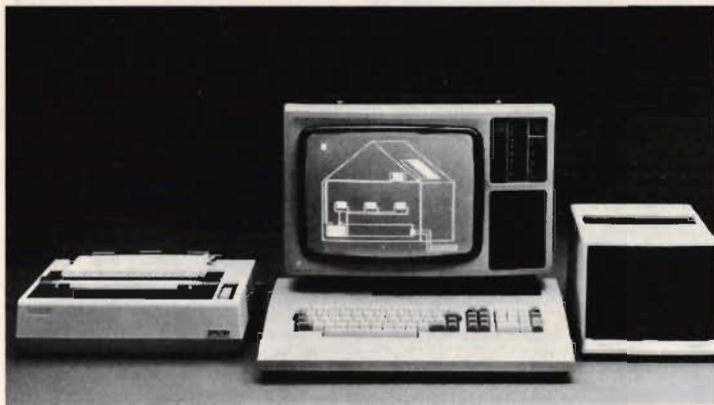
Det "industriella" paketet har färgskärm med 40 tecken per rad, matris skrivare och ett dubbelt flexskivminne.
