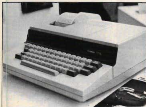
Canon TX-15. En liten fristående kontorsdator med inbyggd skrivare.
