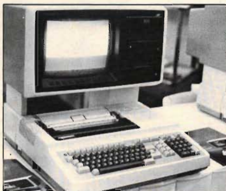
OKI gör inte bara skrivare utan även den här datorn: IF 800. Datorn innehåller såväl bildskärm som dubbla flexminnen och skrivare.
