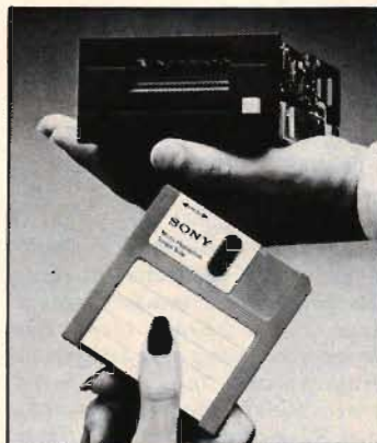
Blir det här framtidens flexskive-system? Bilden visar Sonys nya 3 1/2 tums flexskiva med hela 437.5 kByte kapacitet.
