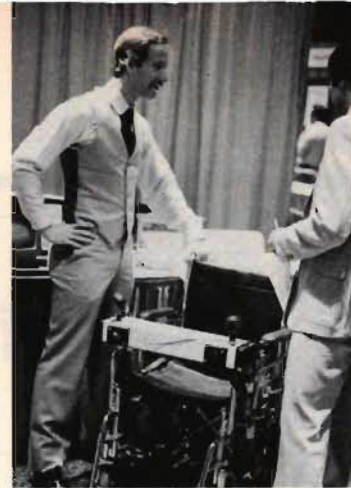
Fig 1. Prototypen på bilden ställdes ut på NCC:s avdelning "personal computing". Längst fram ser vi ultraljudavkännarna som registrerar huvudets läge. Bakom stolsryggen finns datorn som i prototyputförande är relativt stor, men med lite utveckling räknar man med att allt ska på plats på ett kretskort.
