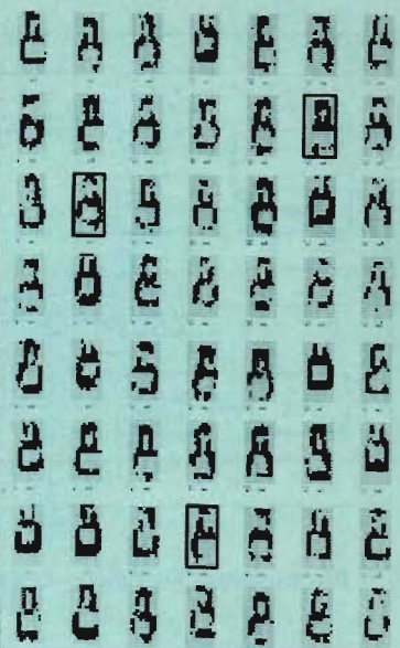
FIG 2. Lästa rasterbilder av en åtta, skriven med OCR-A av en radskrivare. När ögat ser alla bilder på en gång kan det lätt tolka varje tecken, men ett isolerat tecken är nästan omöjligt att tolka med någon tillförlitlighet.
