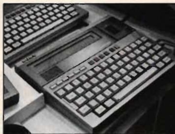
Den här elektroniska skrivmaskinen har inbyggt kassetminne. Texten kan senare redigeras och skrivas ut i ett större ordbehandlingssystem.
