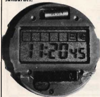
Fig 3. Längst ned till vänster ser vi det lilla uret som är monterat i radiostyrningens sändardel.
