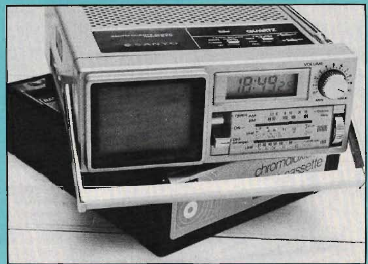
Yttermåtten på den lilla 2,5-tums mottagaren är nästan exakt desamma som den gamla VCR-kassett den här vilar på. Ändå rymmer Sanyo-pysen både tv-mottagare för alla kända system, radio för fm och am samt ett digitalt alarm-ur som kan styra radio eller tv.
