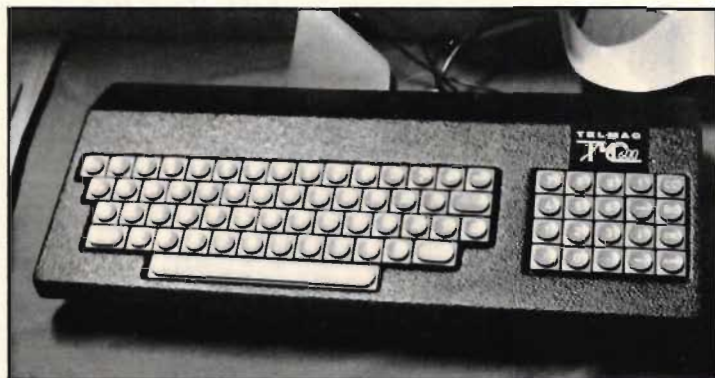
Under. Telmac 600 - finsk dator med minimal effektförbrukning: bara 1,5 W tack vare CMOS.
