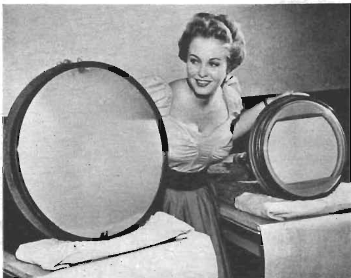
Fig. 4. Färgbildrör från RCA, 53 cm i diam. Vikt 12 kg. Pris 175 dollar. T.h. RCA:s äldre 15" färgbildrör.
