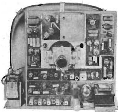
Fig. 7. Komplet TV-mottagare helt uppbyggd av enheter med tryckt ledningsdragnig.
