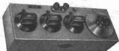
Dekadkondensator med luftkondensator
