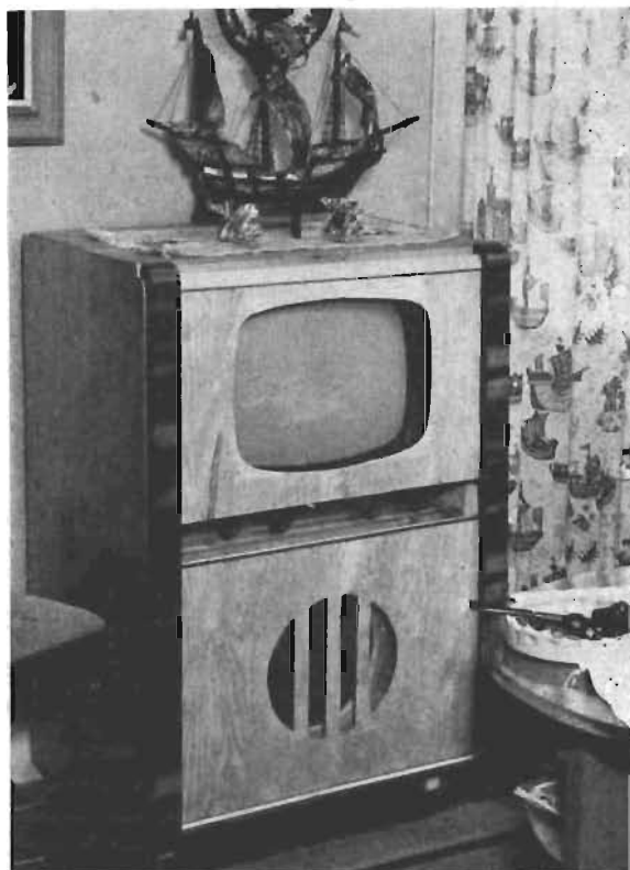
Fig. 91. Den färdiga TV-mottagaren installerad i sin möbel. En glasskiva av 15 mm:s tjocklek bör anbringas i öppningen framför bildröret för att skydda detta och som säkerhet för åskådarna. Bildröret kan nämligen implodera.
