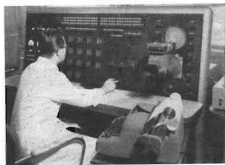
Interiör från Matematikmaskinnämndens lokaler. T.h. kontrollbordet. T.v. stativ med bl.a. Williamsminnet. Längst t.h. elektriska skrivmaskiner, som direkt skriver ner slutresultatet.
