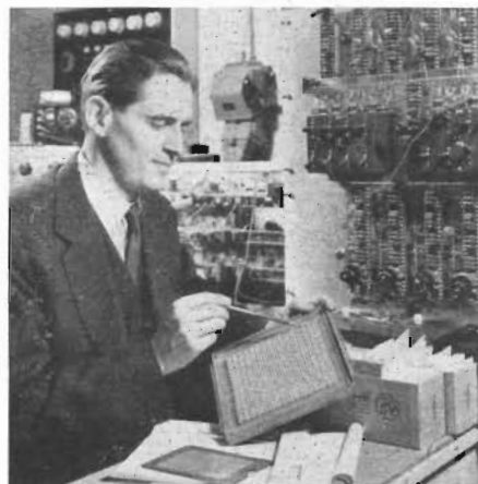
Fig. 16. Artikelförfattaren demonstrerar här en minnesmatris med ferritkärnor.
