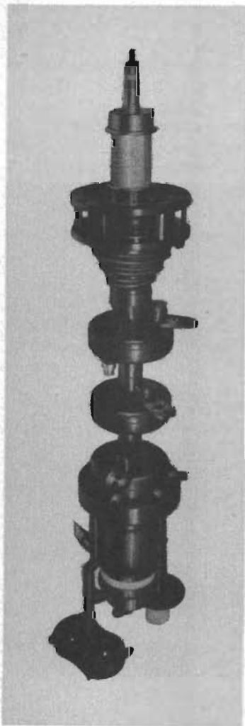
Fig 16 Raytheon's klystronförstärkare QKK824 för L-bandet har en puls-effekt av 1 MW.
