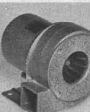
ENGEL turbofläkt totalhöjd 95 mm totaldjup 100 mm 18 m³/h vid 7 mm vp
