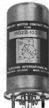
HG2B tvåpolig växling för lödanslutning
