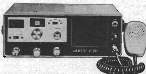
Lafayette HE-20T 5 W 12 kanaler, samt även manuellt avstämbar mottagare. 13 transistorer Pris 985:—
