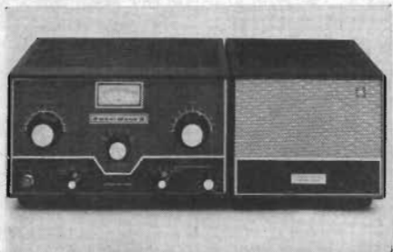
Ovan ses Swan Mark II. Det är en SSB-transceiver för sexmeterbandet med ineffekten 240 W.
