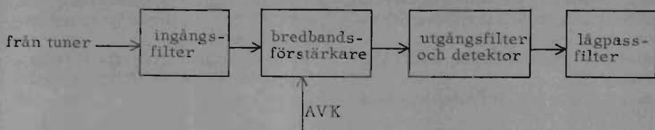
Fig 1. Blockschemat för MF-förstärkare.
