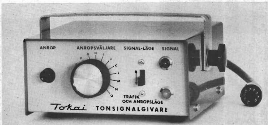
Fig 18. Typisk tonselektivutrustning (kombinerad givare och mottagare) för privatradiobandet. Med användande av sex olika toner i ett dubbeltonsystem kan man sända 15 olika tonkoder. (Tokai).
