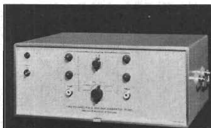
Fig 13. Pulsgenerator för \sin^2 -puls och »balk» (Marconi TF 2905).
