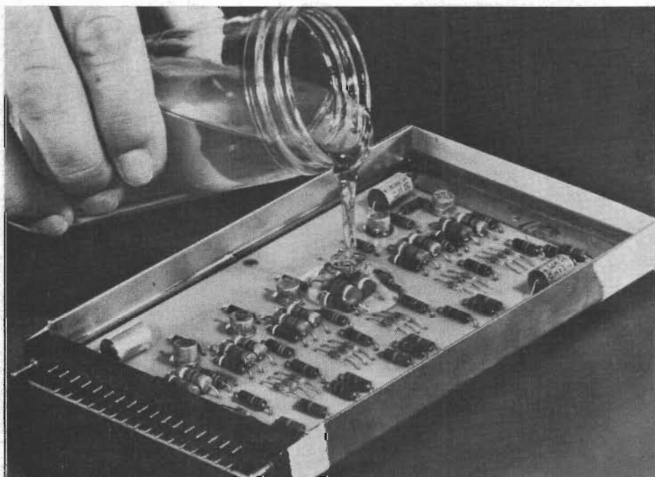
Olöslig Sylgard-harts med låg viskositet hälls över ett kretskort med komponenter. Härdnar vid låg temperatur till ett slags gummiliknande reparerbart hölje.
