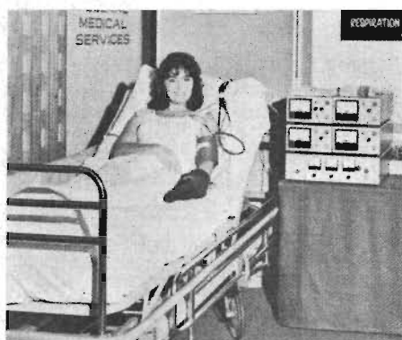
Fig 5. AEL har för sjukhusbruk konstruerat en automatisk patientövervakning som kontinuerligt mäter hjärt- och andningsverksamhet, blodtryck och temperatur.
