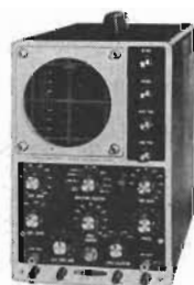
Bredbandsoscilloskop IO-12E 3 Hz–5 MHz, impedans högre än 2,7 Mohm. 5" bildrör.
