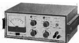
Kraftaggregat IP-27E 0,5–50 V, 1,5 A. Kortslut- ningssäker, inställbar strömbegränsning.
