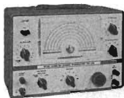
SIGNALGENERATOR SO-108 Kr 325:— 300 x 215 x 165 mm. Vikt 3,5 kg. Frekvensnaggrannhet \pm 1%. Frekvensområden: A: 150—350 KC, B: 350—500 KC, C: 400—1 100 KC, D: 1,1—4 MC, E: 3,5—12 MC, F: 11—40 MC, G: 40—150 MC, H: 80—3 000 MC. Modulation: AM 800 p/s. Ext. mod. Dämpning i 4 steg om 20 dB vardera samt kont. reglerbar med potentiometer. LF 800 p/s på separat utgång och reglerbar med potentiometer. Yttre mod. kan anslutas. Signalgenerator i absolut särklass.
