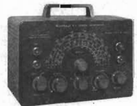
► Signalgenerator SG-8E 160 kHz–220 MHz.
