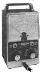
Rörvoltmeter IM-11E 1,5 V–1 500 V AC och DC. Resistans 0,1 ohm–1 000 Mohm.
