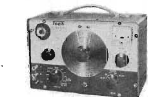
IMPEDANSBRYGGA TE-46 2 pF—5 000 pF, 0,002—0,5 \mu F, 0,2—50 \mu F 50—2000 \mu F, 2 \Omega —500 \Omega , 200—50 000 \Omega 20 K \Omega —5 M \Omega —200 M \Omega . Effektfaktor: 0—75%. Noggrannhet: 5% 193 x 265 x 150 mm. Vikt 4 kg.
