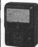
300-Wir DC: 2,5, 10, 50, 250, 1 000, 5 000 V. 50 \mu A, 2,5, 25, 250 mA. 10 A. AC: 2,5, 10, 50, 250, 1 000, 5 000 V. OHM: R \times 1, \times 10, \times 100, \times 1 000. 1 \Omega till 10 M \Omega . dB: —20 till +10, —10 till +22.
