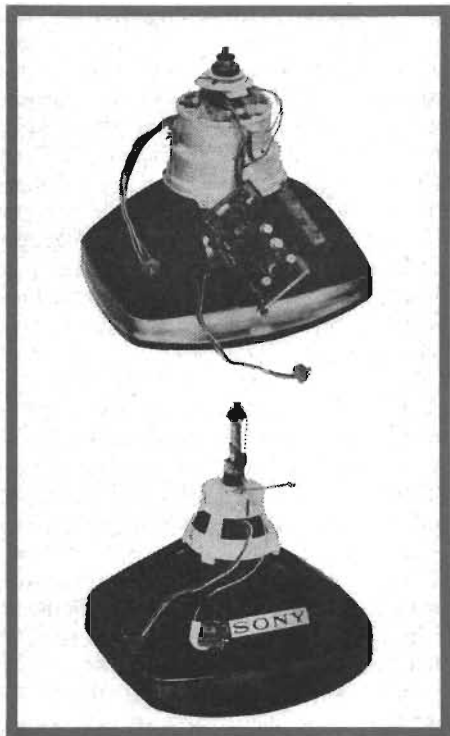
Fig 2. En jämförelse mellan ett konventionellt skuggmaskrör med tre kanoner och ett med Sonys Trinitron.
