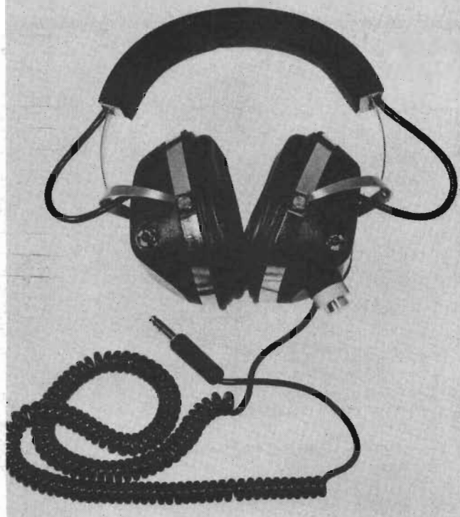
Fig 2. Tung, mörk och gedigen (utom i bygelfästningen): Koss ESP-6. Märk de båda indikatorlamporna på kåporna för nivån! Konstruktionen saknar separat aggregat för polarisationsspänningen; är »självalstrande». Vätskefyllda kåpor på känt Koss-mått. — Foto RT.
