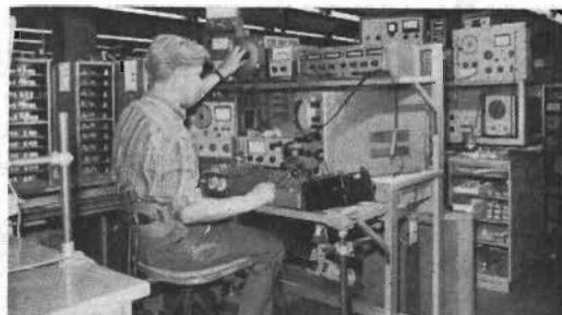
Fig 3. Utrustningen för trimning och provning är modern och omfattande. Här provas en enhet som skall ingå i en kommunikationsradio.
