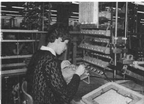
Fig 4. Den av SRA utvecklade komponentelevatoren bidrar effektivt till att minska antalet felaktiga monteringar, tack vare ett sinnrikt lampindikeringsystem.
