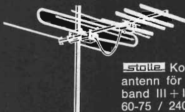
Stolle 23, 43 eller 91 element UHF antenn. X-dipoler. För kanal 21-60. Anpassning 60-75 / 240-300 ohm.
