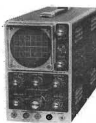
Serviceoscilloskop OS-2E 2 Hz–3 MHz känslighet 280 mV/cm. Impedans 3,3 Mohm/20 pF.
