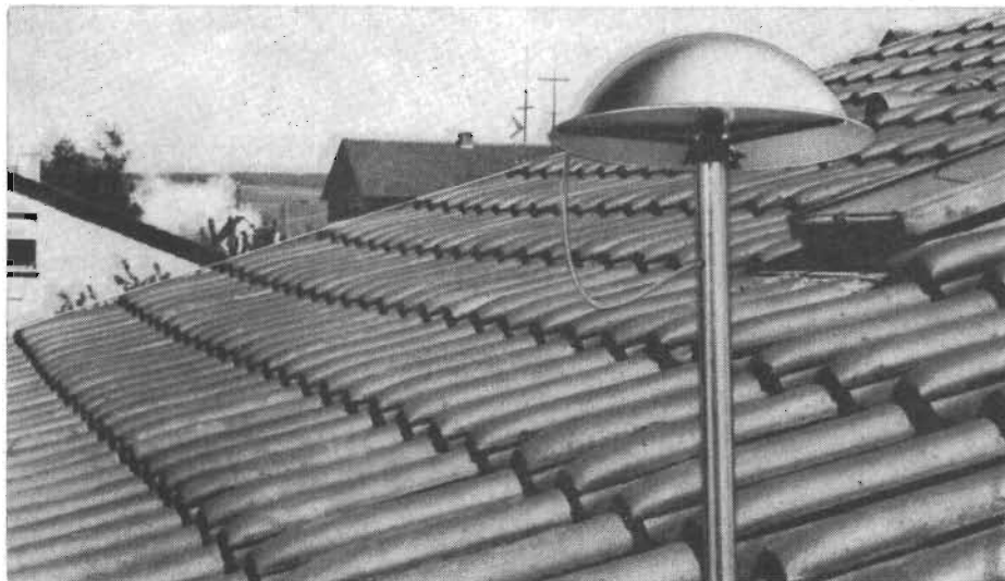
Fig 20. FTE-Maximals bredbandsantenn med 360° riktningskaraktär.
