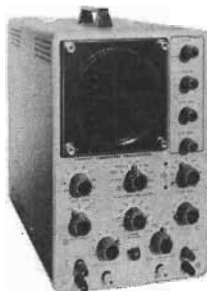
Serviceoscilloskop OS-2E 2 Hz–3 MHz känslighet 280 mV/cm. Impedans 3,3 Mohm/20 pF.
