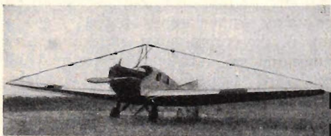
Fig. 5. Junkermaskin med dipol-antenn för kortvågsprov.
