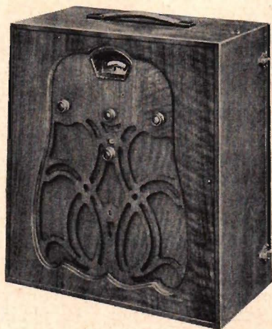
Fig. 8. His Master's Voice, Model 66 , en resemottagare av den nya fyrarörstypen. Rattarna i mitten tillhöra korrektionskondensator och omkopplare. Till höger återfinnes avstämnings- och till vänster glödströmsåterkopplingsratten.
