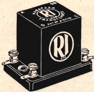
Fig. 5. Parafeed, en lågfrekvenstransformator för anodströmsfri primärinkoppling, som förenar hög induktans (100 H) med små dimensioner.
