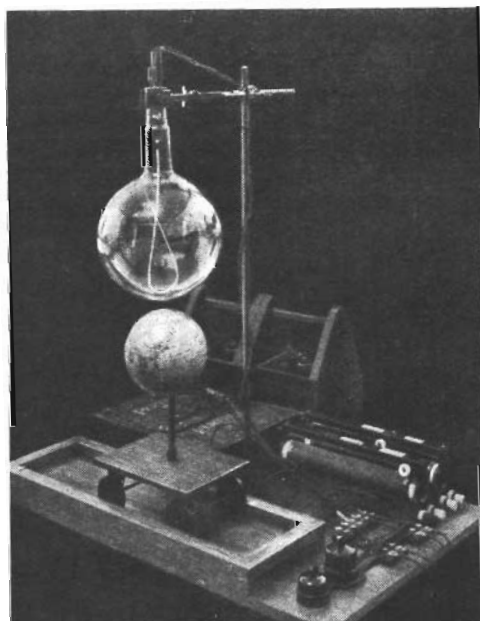
Fig. 6. Försöksanordning med utanför katodstrålsröret befintlig jordglob med inbyggd magnet. Man ser huru katodstrålen inuti röret böjer av framför magnetiska polen.
