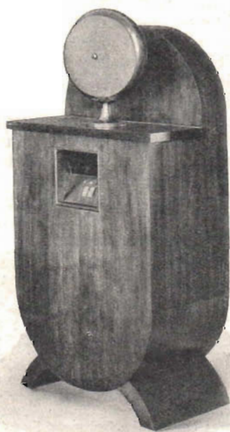
Fig. 11. Tefags 8-rörs nätsuper med inbyggd ramantenn.
