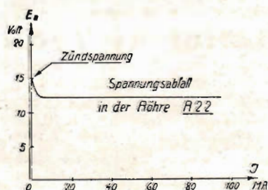
Fig. 6. Belastningskurva för rätapparat med Rectron-rör.
