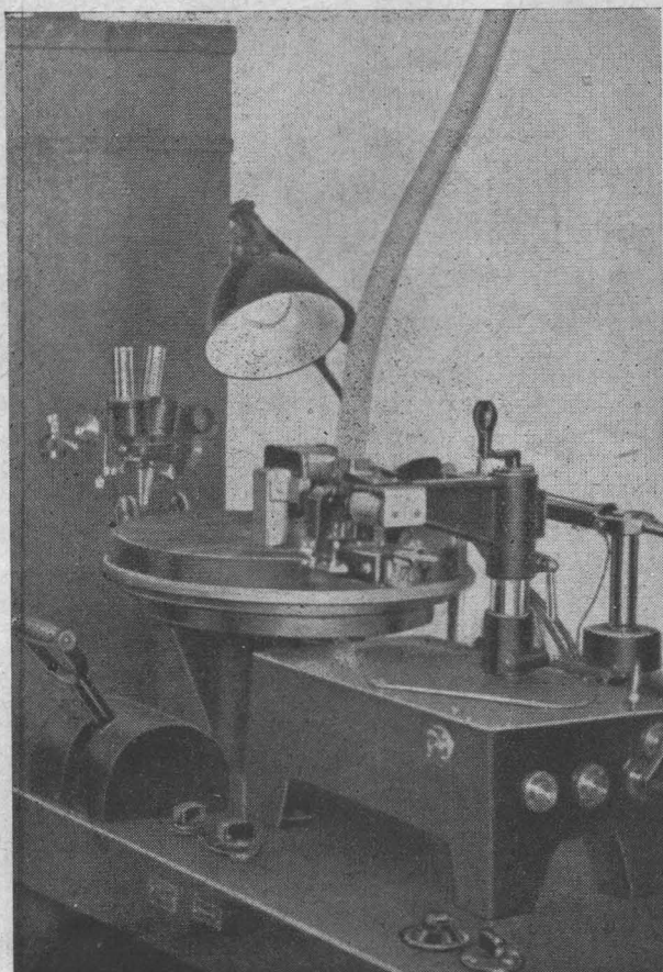
Fig. 3. Med denna apparat graveras vaxplattorna. I bakgrunden synes värmeskåpet.
