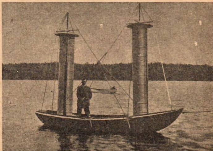
Fig. 3. Den S-formade skovelrotorns verknings-sätt, som närmare förklaras i texten.
