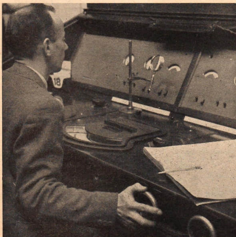
Alla värden på tryck och vindhastighet kontrolleras från denna pulpet, där även de krafter, som påverkar modellen, registreras på elektriska visartavlor.
