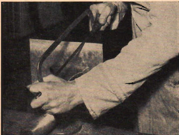
Fig. 15. Dessa hack böra vara ca 5 mm från varandra. De göras bäst med bågfil eller mejsel. Därefter rengöras fogkanterna och plåten närmast dessa med trådborste eller stålull och vatten.
