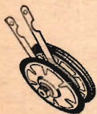
Fig. 3. En strömventil, bestående av två selenplattor, ser ut så här och användes till allströmsmotorer med två fältlindningar.
