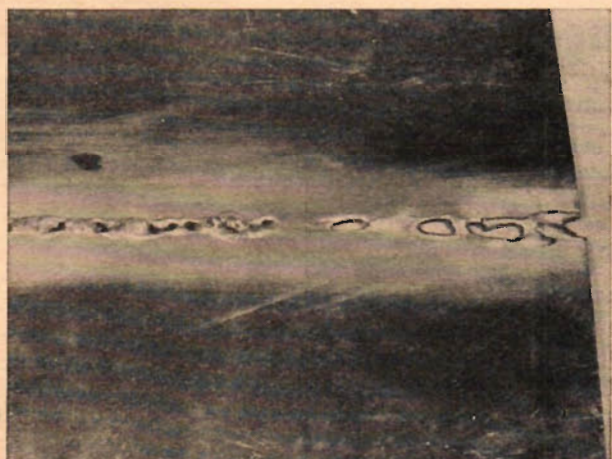
Fig. 27. För stor låga och för långsam svetsning förorsaka stort smältbad, som lätt faller igenom. De äro här orsaken till hålen i svetsen. Välj lagom lågstorlek — ca 80 liter acetylen per mm godstjocklek.
