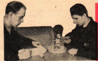
Yrkeklärare Gotth. Johansson vid Scania Vabis kontrollerar hur försökspersonen med hjälp av sin muskelkänslighet bedömer friktionsförhållandet vid Moedes bultinpassare.
