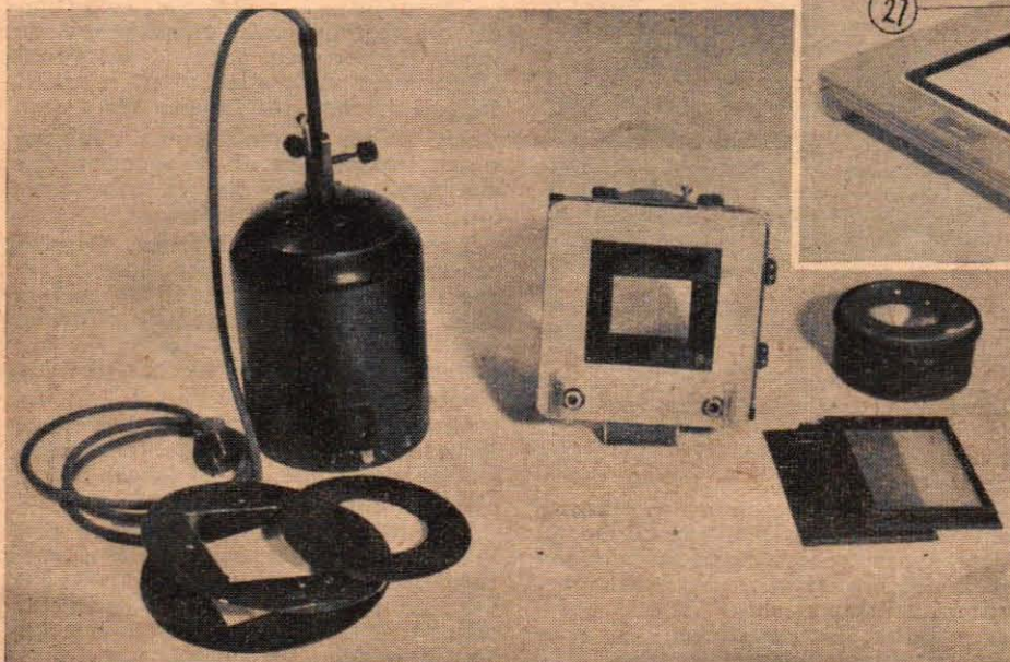
Ovan en bild av den färdiga förstoringsapparaten. På detaljfotot t. v. synes från vänster negativhållaren med mellanring, övre lamphuset, undre lamphuset med avmaskningslinjaler, kondensorn, samt kassett och visirskiva.
