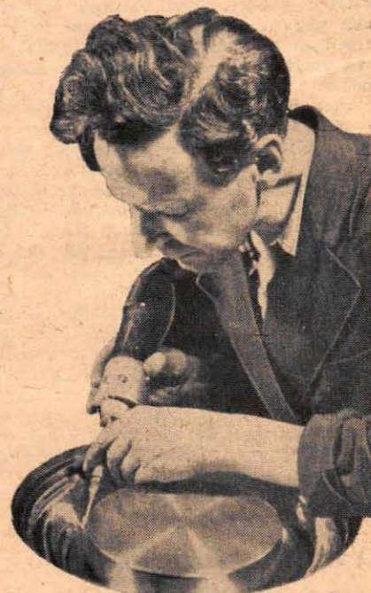
Fig. 387. Slipning av pressverktyg med handslipmaskin.
