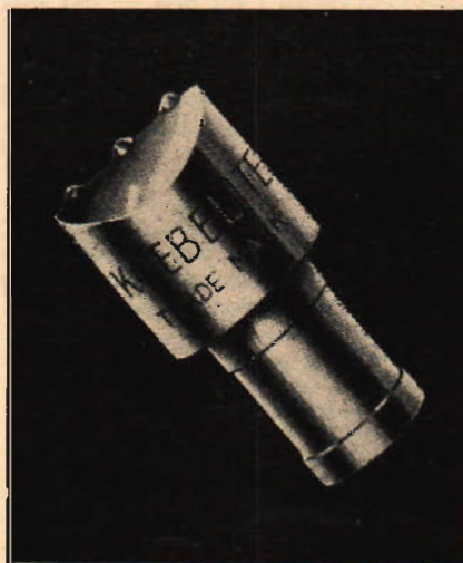
Fig. 395. Verktøy med tre diamanter. För rivning av raka slipbanor.
