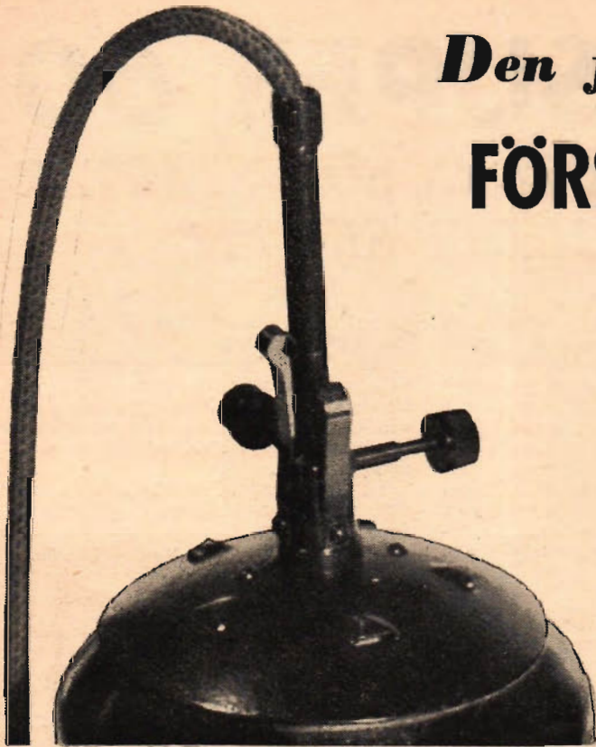
Bild 1. Taket och centrerranordningen på lamphuset. Genom att vrida på rattarna ändras lampans riktning och höjdläge.
