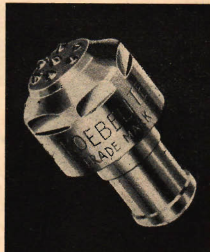
Fig. 396. Verktøy med sju diamanter. Särskilt avsett för centerlesslipning.
