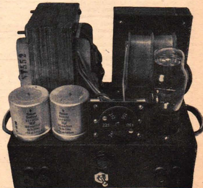
Fig. 1. Likriktaren i färdigt skick. Längst bak till vänster syns transformatorn. Framför transformatorn är de båda elektrolytkondensatorerna placerade. Till vänster ses drosseln och mellan röret och elektrolyterna skymtar spänningssomkopplaren.
