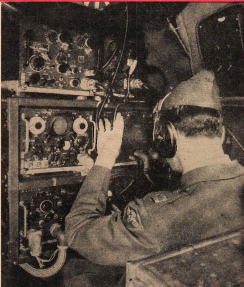
T. v. Anti-ekoradioanläggningen i ett av de stora amerikanska bombplanen. Övan: Fiskerkroken, en störningsantenn, som visade sig effektiv mot luftvärnets ekoradioanläggningar.
