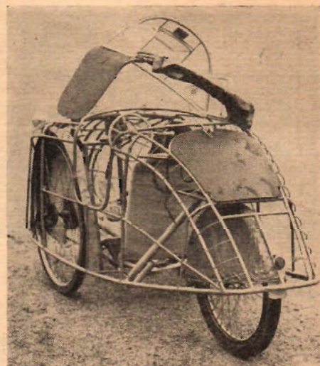
Ovan syns hur vagnens "dörrkonstruktion" lösts. Den åt höger fällbara huven uppbär suffletten samt vindruta och sidofönster. Bagageluckan längst bak är för tillfället stängd.
