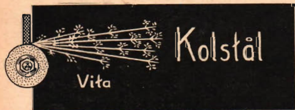
Fig. 403. Slipngnistornas utseende vid "verktygsstål" (kolstål 1,25 % C).
