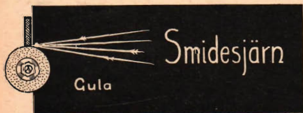
Fig. 402. Slipngnistornas utseende vid bearbetning av smidesjärn (kolstål 0,10 % C).
