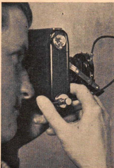
Gammal kamera försedd med den här beskrivna hållaren för metalltrådsutlösare. Ritning till hållaren återfinns i spalten till höger.
