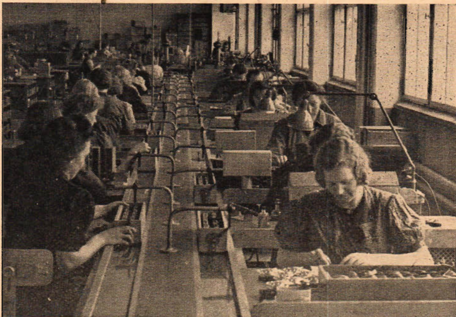
Hopsättning av fingerskivor för telefonapparater vid Telefonaktiebolaget L M Ericsson.
