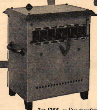
Typ 1355 en liten transformator med hög verkningsgrad och låga strömkostnader, avsedd för varierande svetsarbeten med elektroder upp till 3,25 mm. Svetsströmmen kan regleras mellan 20 och 135 A.
