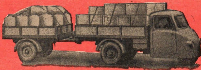
Den trehjuliga italienska lastvagnen Aer-Macchi i arbete. På omslagsbilden ser man den i "avklätt" skick. Vagnen har en tvåcylindrig motor, som drar ca en liter pr mil, och gör 70 km/tim.
