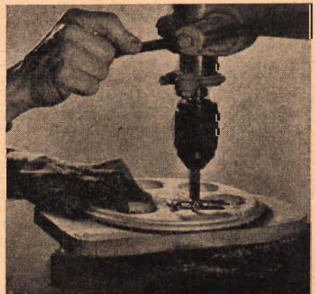
En ställbar borrar skär ut hålen för glaset. Hälcentra erhålles ur detaljritningen.
