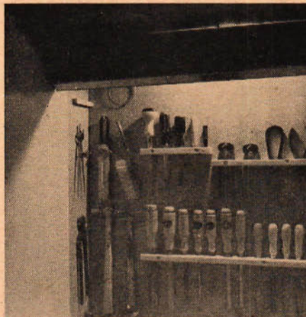
Av bilden framgår tydligt hur det avskärmade ljuset faller ned på arbetsbordet samtidigt som verktygsuppsättningen är fullt belyst.
