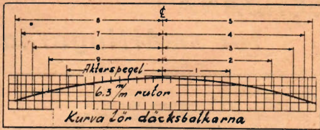
T. v. Ritning på däcksbalkarnas ytterkonturer. Förstorad till full skala.
