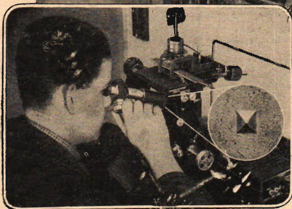
Hårdbetskontroll efter härkning. Den infällda bilden visar ett hårdbetsprov utfört med diamantpyramid i mikroskop.
