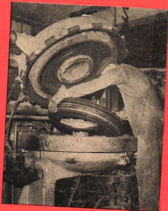
Sedan däckets är ordentligt "bakat" öppnar sig formen automatiskt och den färdiga produkten kommer fram.
