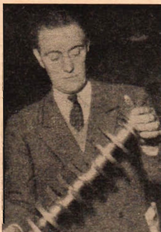
Amédée Gordini själv demonstrerar här en härdförkromad och nyslipad vevaxel till en av sina 1440 cc racers.
