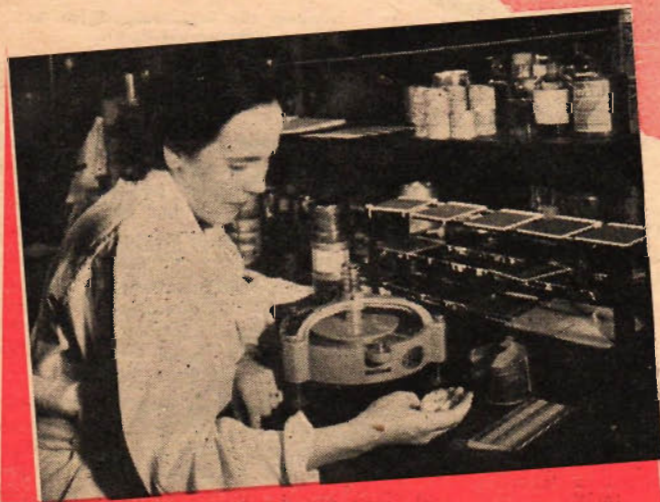
En bild från ett av Beckers kontrollaboratorier, där flickan arbetar vid en apparat, som bestämmer en färgs flytningsförmåga.
