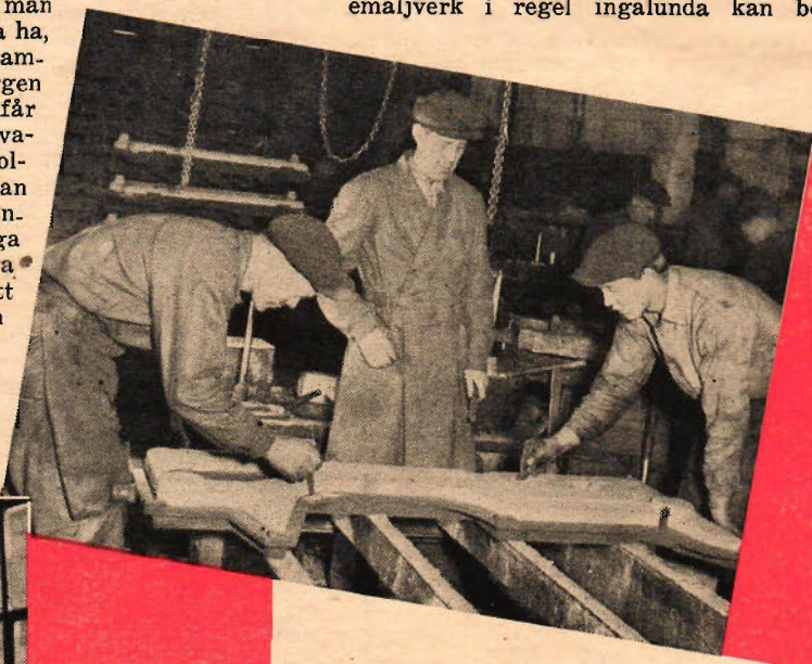
Ovan: Gjutning av en pannsektion — värmpannor är en av Norrahammars "stora" produkter. T. v.: Ett par av ugnarna i emaljverket. T. h. ser man hur godset körs in på trallor.
