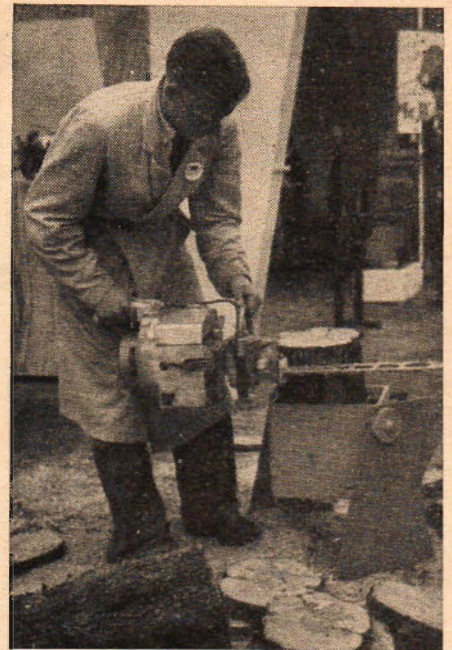
Be-Ho enmans motorsåg i arbete. Den används för fällning, kapning och kvistning. Den går igenom en ordinär stock på några sekunder.
