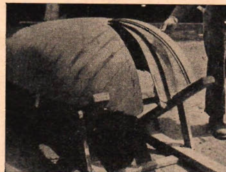
Bygg upp stäven av tolv bitar faner eller av tre bitar \frac{1}{4} " virke och falsas som ritningen visar.
