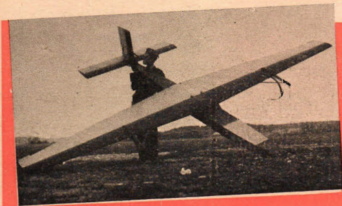
För att göra målbogseringen mera realistisk har man numera frångått de tidigare "korvarna" och i stället gått in för s. k. vingmål av den här typen.
