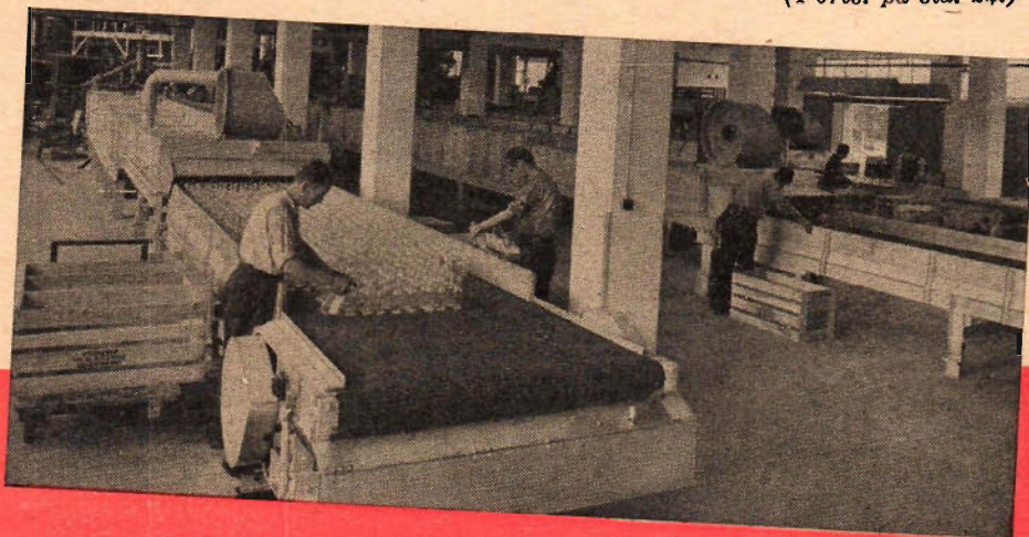
Fig. 6. Flaskorna synas noga efter passagen genom kylröret. Detta är vanligen numera elektriskt, varvid en automatisk temperaturreglering med stor noggrannhet befriar glaslet från alla inre spänningar. En förutsättning för kvalitetsglas!
