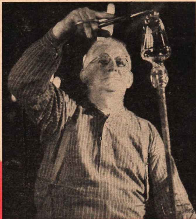
Fig. 5. "Benmakaren" avklipper smält glas för formning av glasets ben.
