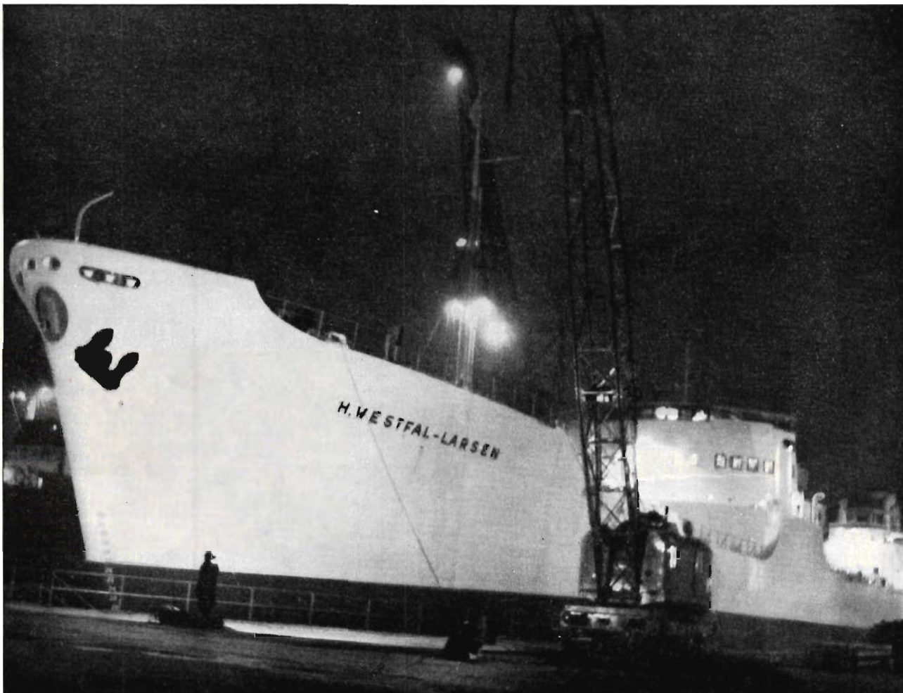
m/1 H. Westfal-Larsen. Leveransår 1950. Lastförmåga 16 080 tons d.w. Fart 15 knop. Beställare Westfal-Larsen & Co A/S, Bergen.
