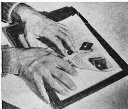
Vid kopiering enligt reflex-metoden placeras det fotografiska papperet med emulsionssidan upp. Originalet läggs i kontakt med emulsionen.
