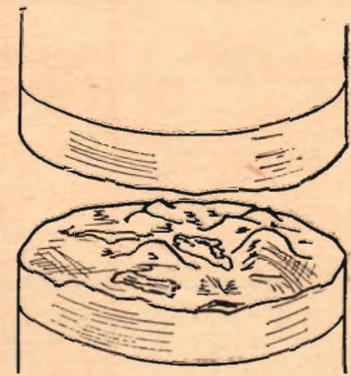
Fig. 9. Bränd kontakt kan vara orsakad av föroreningar eller dålig inslipning.
