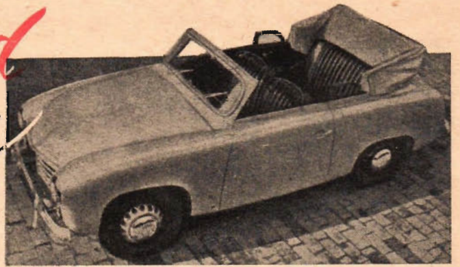
I vinjetten: Även Goliath-Cabrioleten har börjat tillverkas med direktinsprutad 2-taktare.
