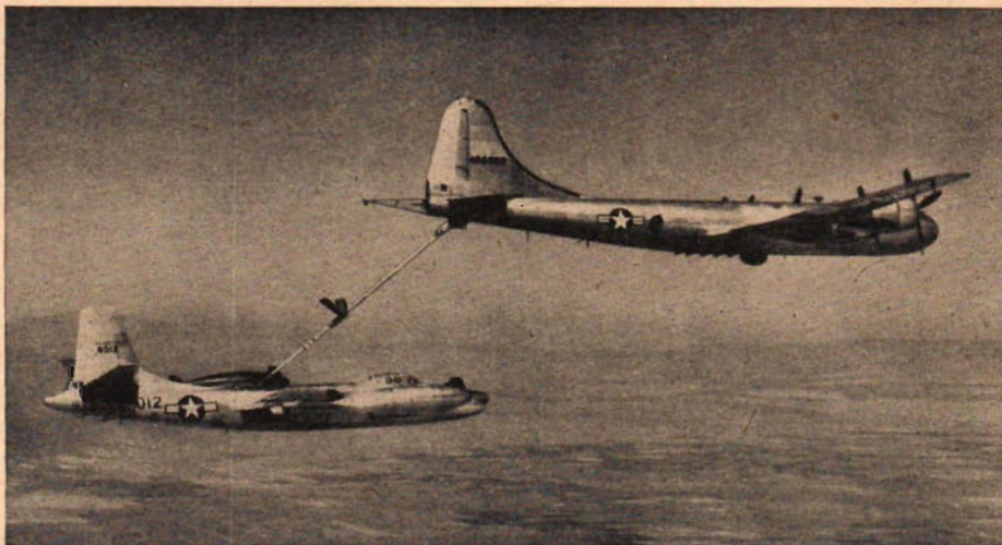
En North American RB-45C Tornado — fyrmotorig jettbombare — har genom Boeings tankanordning "Flying Boom" fått rörförbindelse med tankaren KB-29P, en modifierad B-29.
