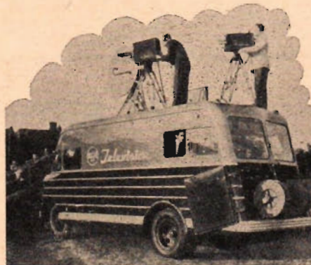
Reportagebilen sänder sina upptagningar direkt till huvudstationen per mikroovåg via den riktade antennen med reflektorn, som skjymtar bakom den främre kameran.
